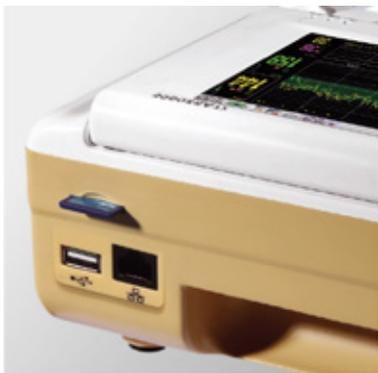
Admite el almacenamiento de datos y actualización de software mediante memoria USB externa. Tarjeta SD externa opcional, para transferencia de datos.
